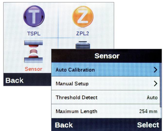
Schritt 2: Kalibrieren am LCD-Farbdisplay
